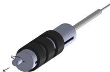
**Figura 10: Destravar o botão do fio trava e remoção completa deste.**
