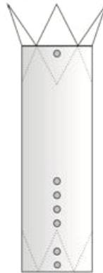
**Figura 5: Desenho esquemático das marcas radiopacas adicionais das Endopróteses Vasculares Ortic.**
